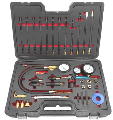
K8106 MASTER SET Compressiemeter en drukverlies tester benzine & diesel. Compressiometre et testeur de fuites de cylindres diesel et essence 359 €
