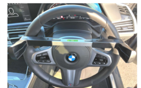
3894-WW Uitlijngereedschap stuurwiel. Niveau pour volant
